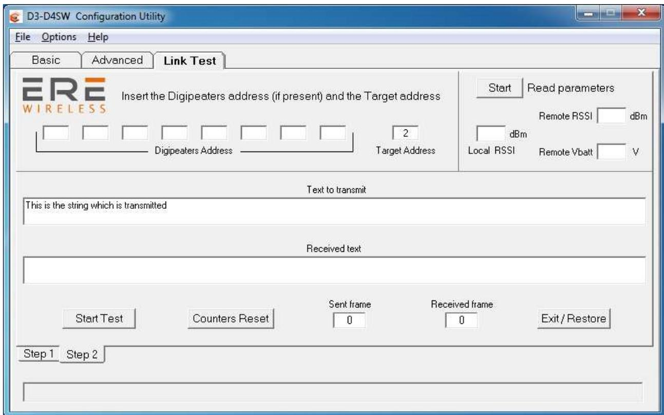
In questa pagina del configuratore è possibile effettuare il test di comunicazione dei radiomodem e visionare la qualità del segnale radio sulle unità interessate.
